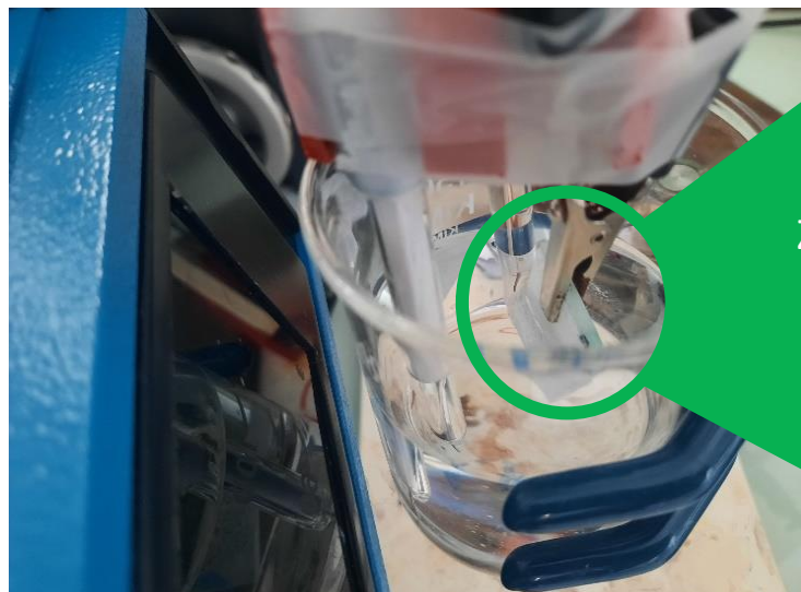
Figure 7 – Photographie des trois électrodes immergées dans la solution de potasse : électrode de travail (E.T.), contre-électrode (C.E.) et électrode de référence (E. ref).
