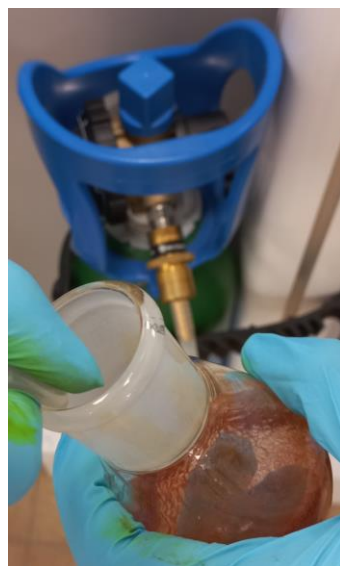
Fig 16 : Mise sous atmosphère inerte d'argon (conservation du produit)
