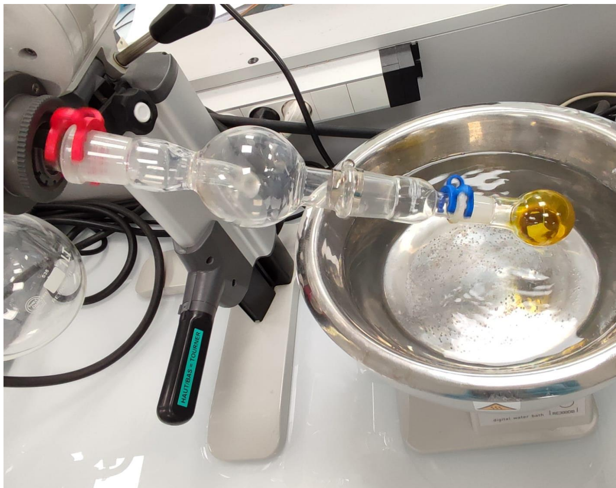
Fig 15 : Évaporateur rotatif : évaporation du \text{CH}_2\text{Cl}_2
