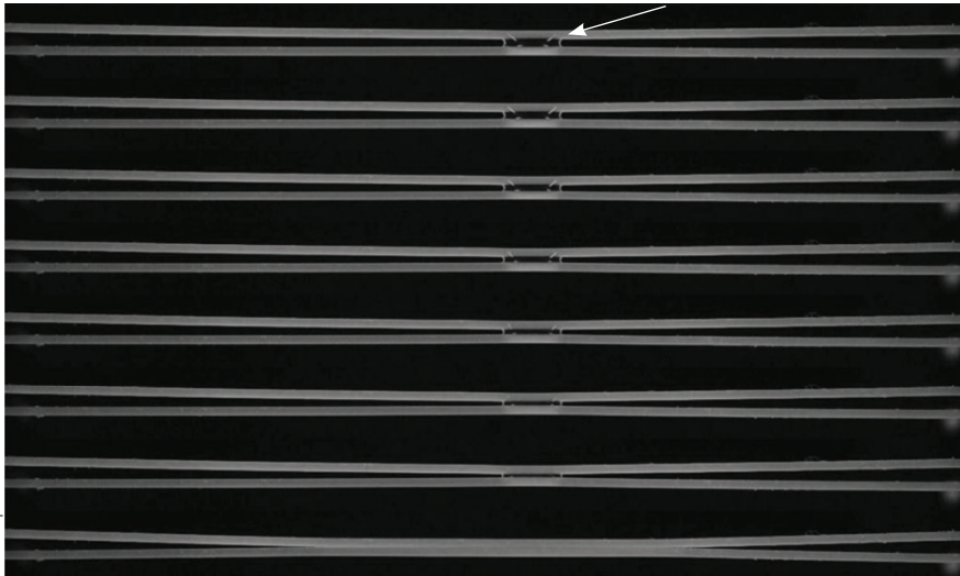
E1. Évaporation d'une goutte (indiquée par une flèche) déposée sur deux fibres flexibles : effondrement des fibres dû aux forces capillaires, en partie à l'origine du rétrécissement observé lors du séchage des textiles.
