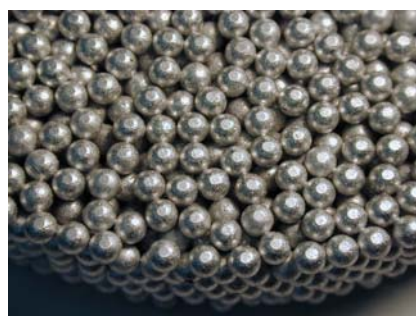
Figure 1 – Un des échantillons utilisés pour l'observation de la localisation d'Anderson des ondes élastiques. Il est composé de billes d'aluminium de 4 mm de diamètre, brasées pour former un réseau élastique désordonné.
