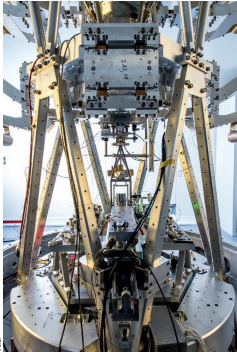
1. La balance de Kibble du LNE. Voir le schéma de la figure 2, page 21.
