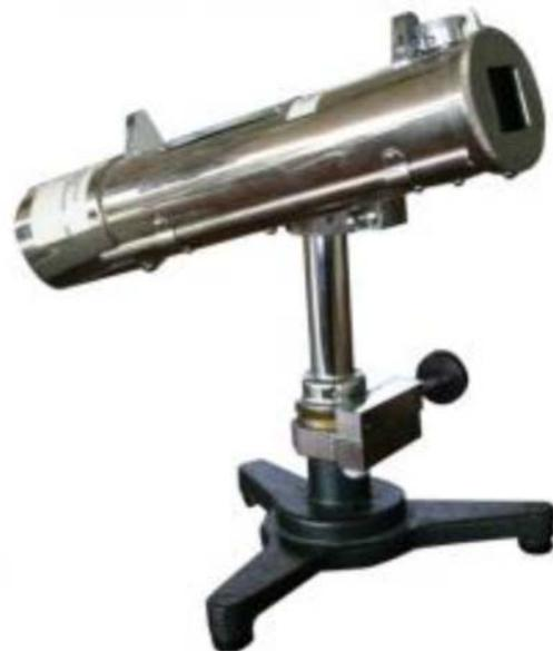
Deux chambres identiques contiennent deux fines lamelles identiques de Manganine. L’une s’échauffe sous l’effet du rayonnement solaire, l’autre est échauffée par un courant la parcourant (effet Joule) de manière à atteindre la même température que la première. La puissance solaire reçue est alors égale à la puissance électrique déduite du courant dissipé dans la deuxième lamelle à l’équilibre.
