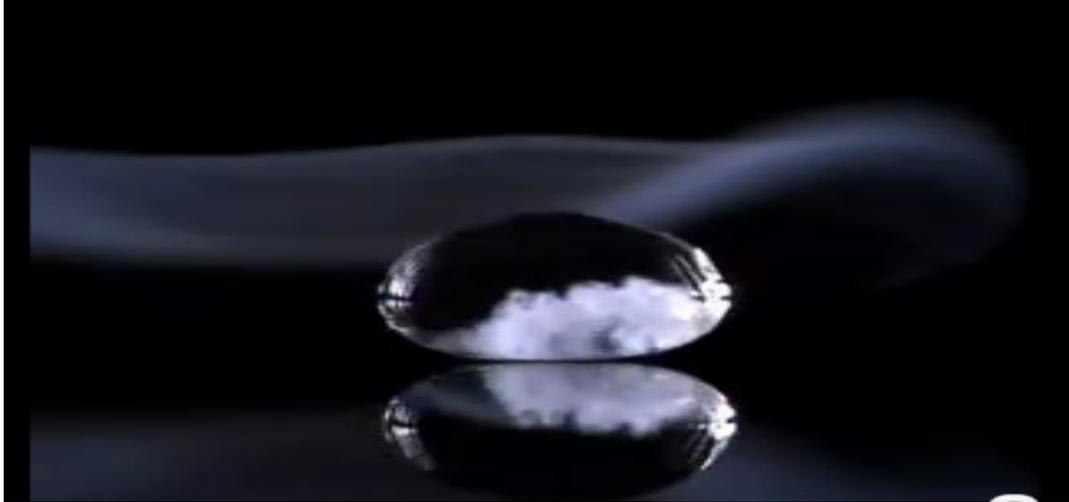
Cette goutte d'azote liquide lévite, portée par le flux de vapeur qu'émet sa face inférieure au contact d'une plaque chaude. Une fois le diamètre de sa face inférieure devenu plus petit que l'altitude de lévitation, la goutte bondit avant de disparaître.
