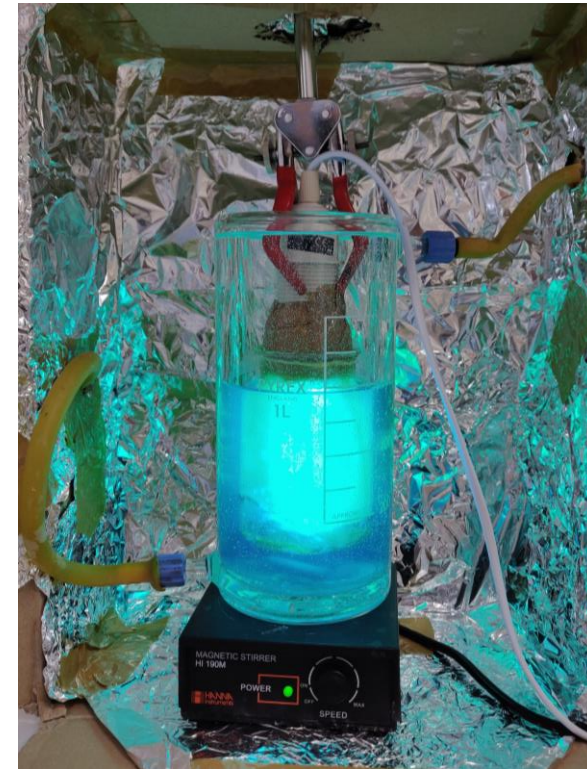
Mise en place de la solution et allumage de la lampe
