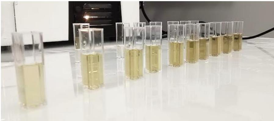
Cuves de différentes concentrations en substrat (pyrocatechol) après catalyse enzymatique au contact de l'air
