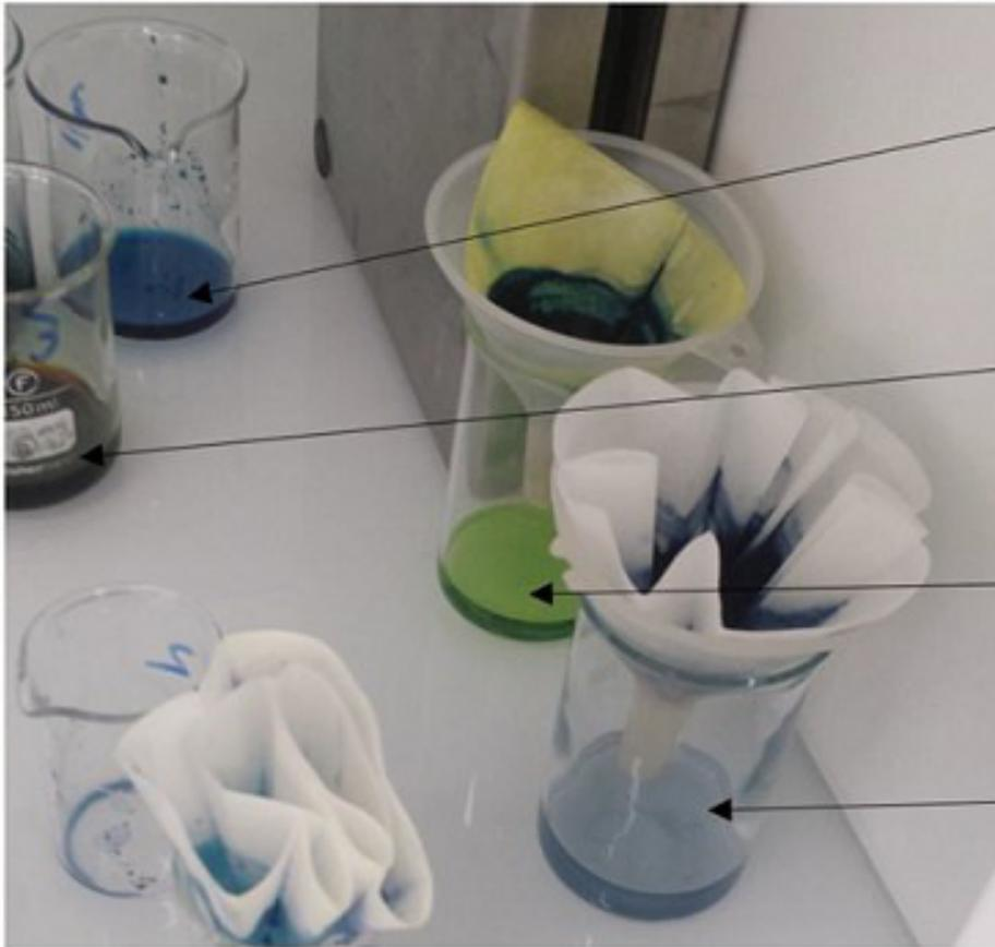
Bleu de prusse formé avec Fe(II) et hexacyanoferrate(III)
