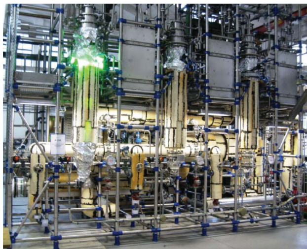
Figure 7 - Synthèse industrielle de l'artémisinine impliquant une réaction de photooxygénation (procédé de Sanofi).
