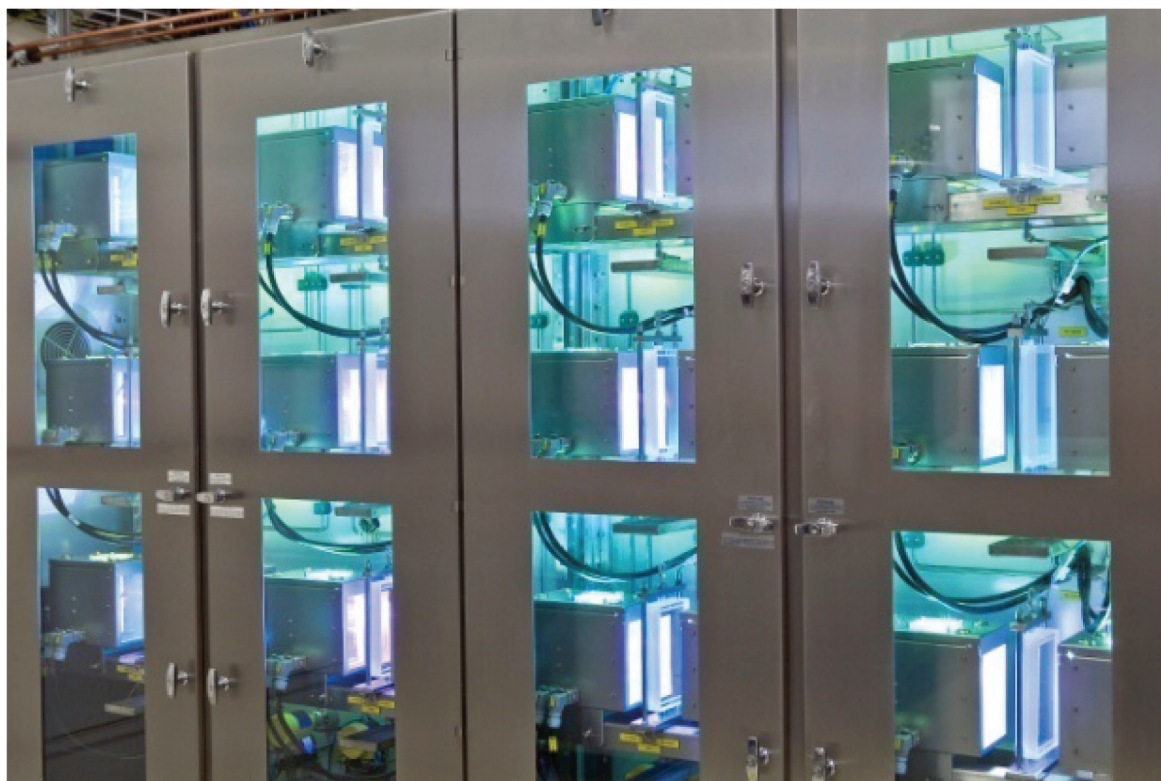
Figure 2 - Réacteur photochimique à lit plat et à flux continu : montage (en haut) et unité de production avec douze réacteurs individuels (en bas).
